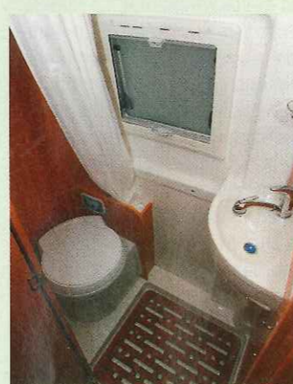
Pivotante, la cuvette de WC ne chevauche pas le receveur de douche.
